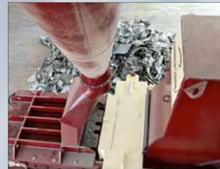
aspirazione | air extractor
