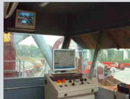
cabina di comando con sistema di gestione
