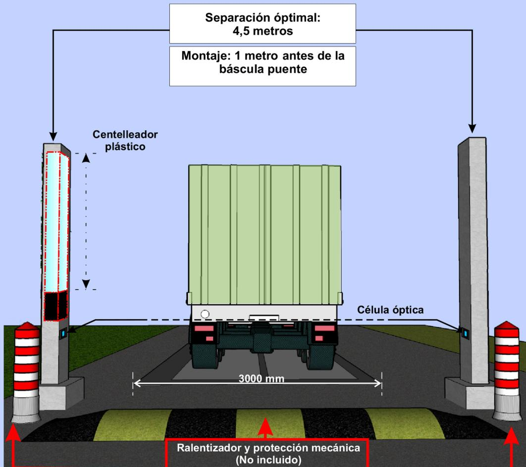
Los planos de ingeniería, que varían en función del modelo de pórtico, le serán entregados cuando realicemos nuestra visita técnica (ingeniería = paso de cables y vigas de hormigón).
